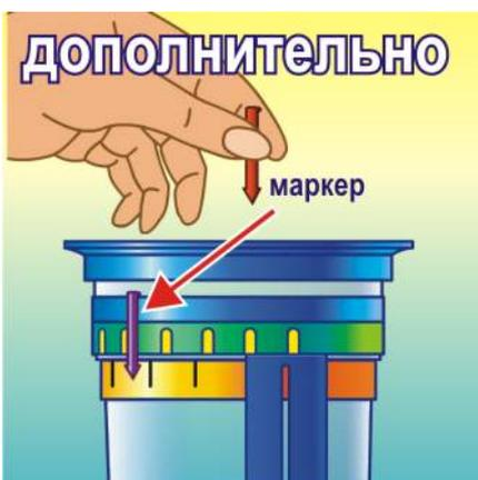
Установите на кольцо шкала 1 (шкала соотношений) прилагаемый в комплекте пластмассовый маркер, стрелкой вниз, на значении, рекомендуемом производителем вашего двигателя. Поворотом кольца совместите установленный маркер со значением необходимого вам количества топлива. На пересечении визира (указателя) и результирующей линии зафиксируется уровень необходимого объема масла. Заполните емкость маслом до этого уровня. Смешайте отмеренное количество масла с необходимым количеством бензина.
